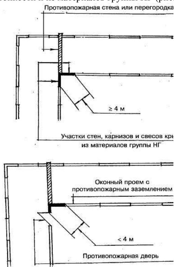
Рис.6. Участок стены в местах примыкания частей зданий под углом, разделенных противопожарными стенами
