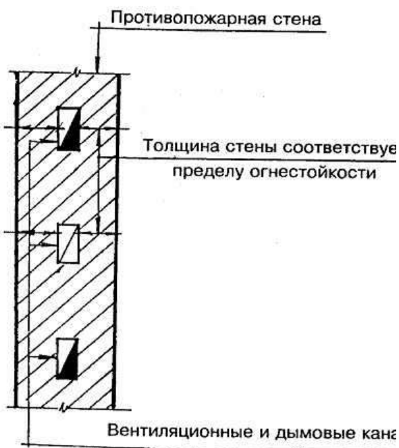
Рис. 10. Пересечение противопожарных стен, зон и перекрытий 1-го типа каналами, шахтами, трубопроводами
